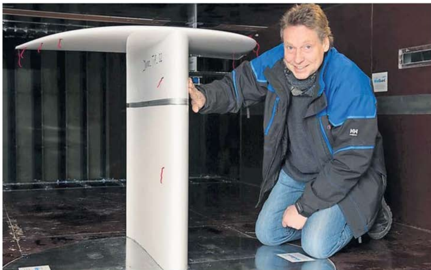
Rolf Rohden mit einem Modell einer Rotorblattspitze, das im Windkanal Bremerhaven getestet wird.
